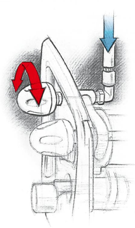
Les bains à bulles sont un plaisir pétillant. Un régulateur distinct permet de moduler la quantité d'air. Los baños de burbujas de aire son un verdadero placer. La cantidad de aire se puede regular libremente mediante un regulador separado.
