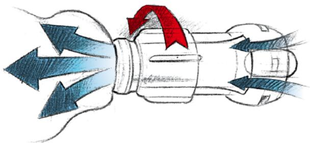
Par une simple rotation. L'intensité du débit peut être réglée — dans l'un ou l'autre sens. Con un simple giro. La intensidad del chorro de agua se puede regular girando el accionamiento, en ambas direcciones.
