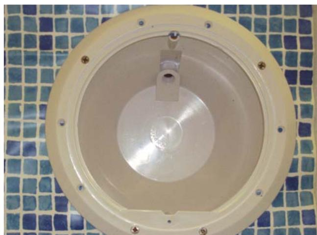
3. Passez le câble du projecteur dans le presse-étoupe. Huilez ce câble (huile ménagère) et laissez environ 60cm (pour le changement de l'ampoule). Serrez bien le presse-étoupe pour assurer l'étanchéité et positionnez le projecteur.
