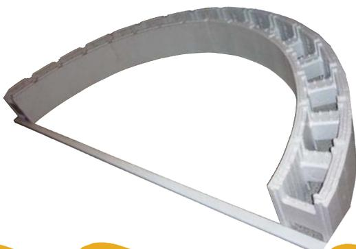
Le bloc cintrable a les mêmes dimensions que le bloc droit : 1m de long x 0.25 de large x 0.30 de hauteur. Pour cintrer le bloc : poser celui-ci sur une surface plane et ferme (fond de piscine) et faire descendre le coin d'insertion, pointe en bas, en appuyant des 2 mains et en relevant l'ensemble par à-coups pour laisser le bloc se déformer.
