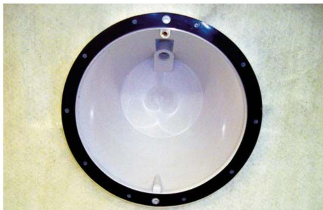
4. Positionnez le tube passe câble sur l'embout prévu de la PAS. Passez le tube dans la découpe, placez la PAS en récupérant le tube par le haut. Vous pouvez maintenir la PAS à l'aide de 4 vis à bois que vous enlevez une fois le béton coulé et séché. Collez le feutre. Collez le premier joint méticuleusement.
