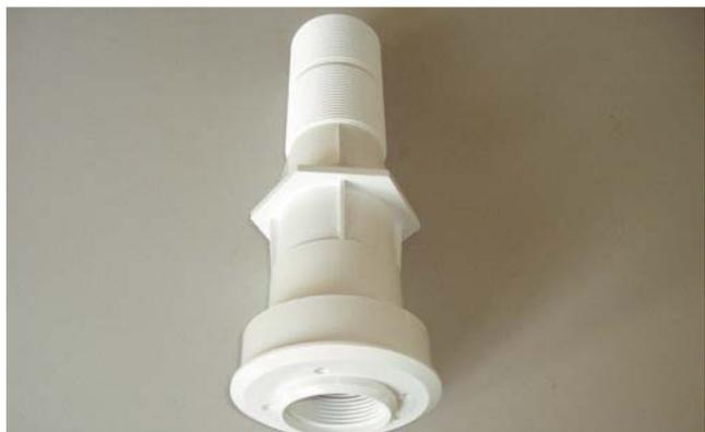
3. Puis, découper l'arrière du bloc coffrant 60mm. Avant de placer la traversée de paroi il faut visser la pièce à sceller sur cette traversée de paroi en ayant mis 25 à 30 tours minimum de Téflon sur le pas de vis de la pièce à sceller. Visser à fond.
