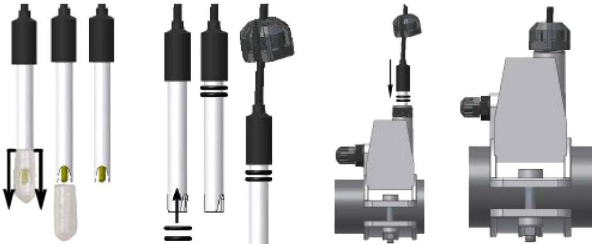
**Fig. 3 - Montage de la sonde dans le porte-sonde**
