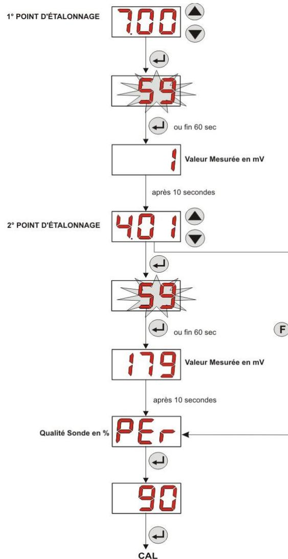
Fig. 14 - Menu Étalonnage de la Sonde pH
