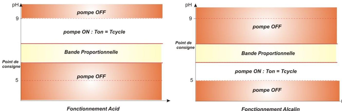
**Fig. 10 - Schémas de fonctionnement acide et alcalin**
