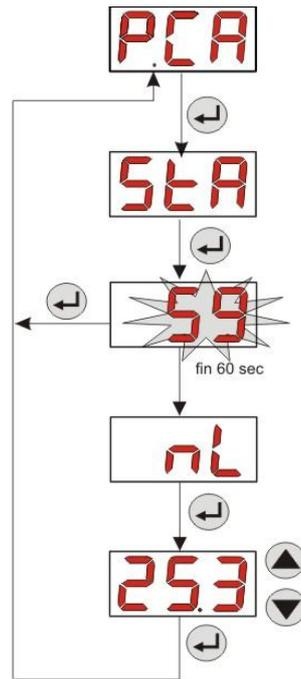
**Fig. 17 - Menu Étalonnage Pompe pH**
