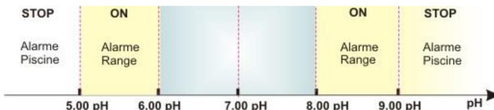
**Fig. 20 - Alarme Range et Alarme Piscine**
