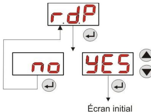
**Fig. 18 - Restauration des paramètres par défaut**
