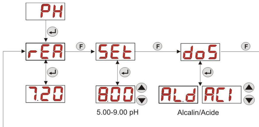
**Fig. 13 - Configuration des paramètres dosage depuis la Programmation**
