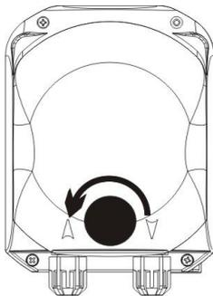
**Phase 2** - Rotation du rouleau dans le sens horaire et décrochement de la bague d'aspiration
