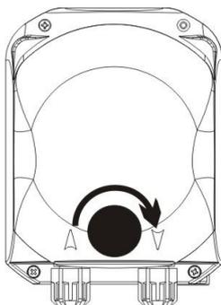
**Fig. 22 - Repositionnement du tuyau péristaltique****5.3 RESOLUTION DES PROBLÈMES****Problème : la pompe ne s'allume pas, le LED et l'écran restent éteints****Solution :**
