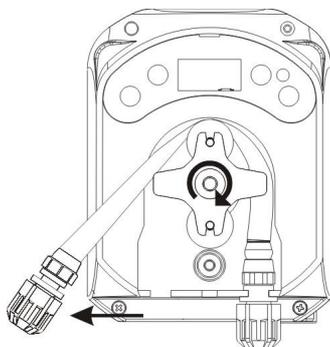
**Phase 4** - Décrochement de la bague de refoulement (droite) du logement et
