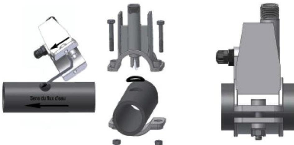
**Fig. 2 - Montage du Porte-sonde**
