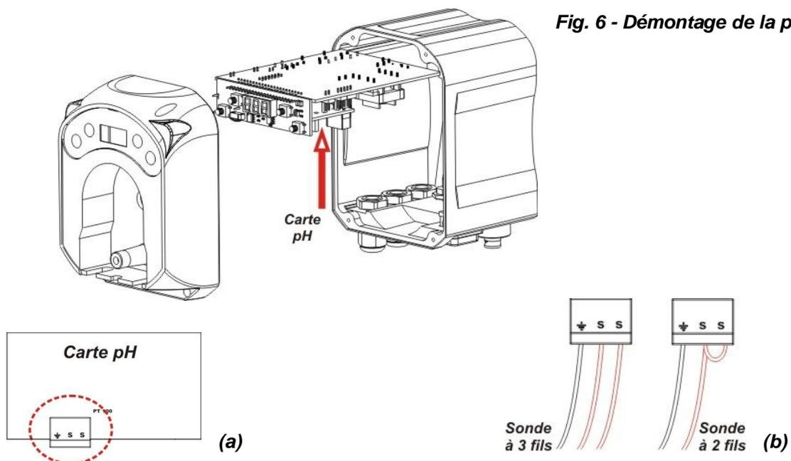
**Fig.7- Carte pH et branchement de la sonde de température**
