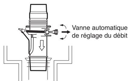
La vanne permet de réguler le débit afin d'assurer un fonctionnement correct de la pompe et du robot. Elle est pré-réglée en usine afin d'optimiser les performances du robot mais possède trois positions de régulation de débit possibles.
